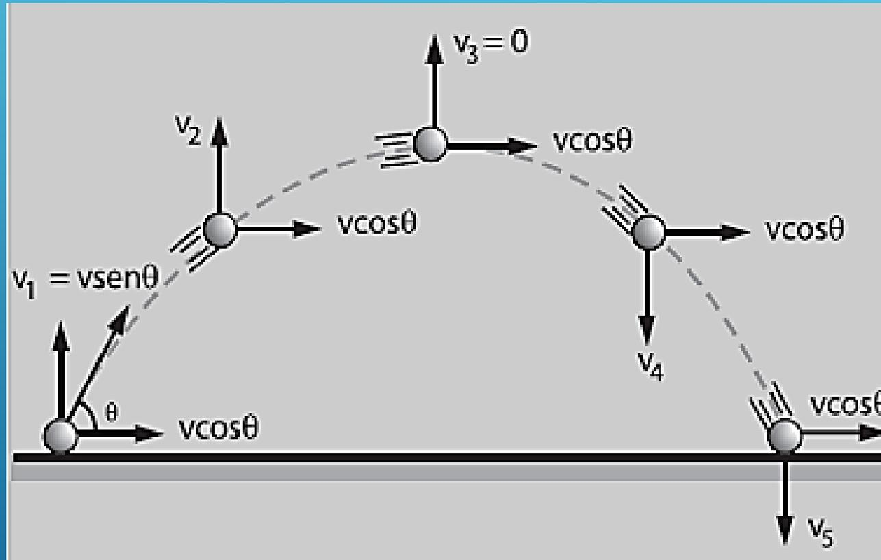
*Si un cuerpo se lanza formando un determinado ángulo con la horizontal, éste describe una parábola como trayectoria; la componente vertical de la velocidad disminuye conforme el cuerpo sube y aumenta conforme el cuerpo cae, en cambio la componente horizontal permanece constante.*
